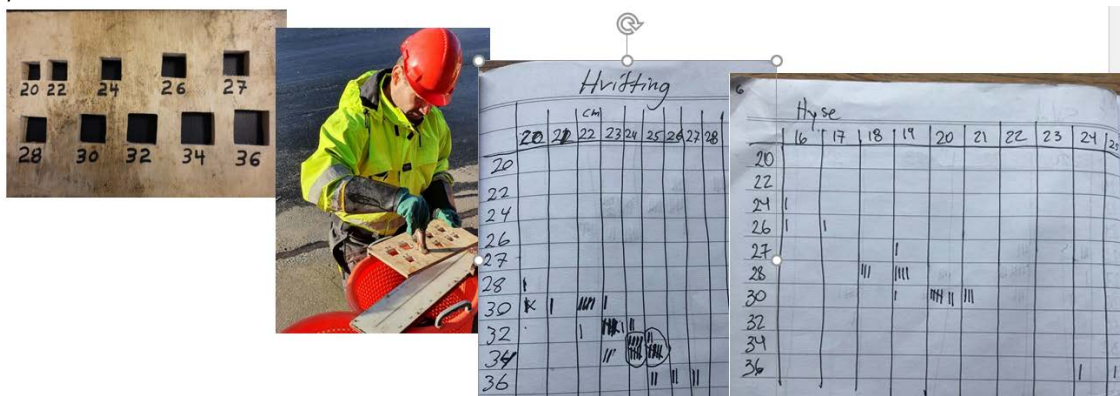
Figur 5: Til venstre vises fall-through plate som simulerer 10 kvadratiske maskevidder fra 20-36 mm stolpelengde. Andre bildene viser innhenting av fall-through data.
